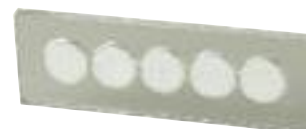
Ammonia electrode membrane, 5190-0543
